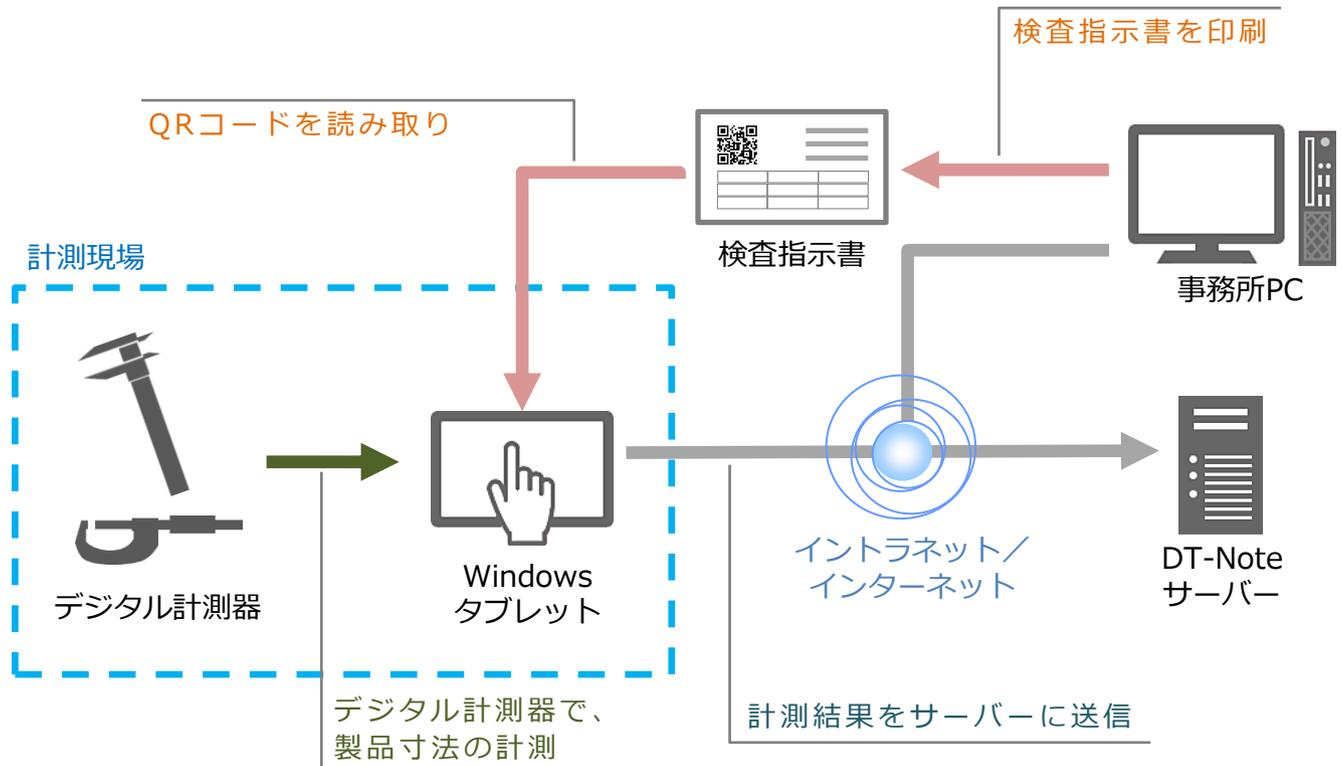
事務所PCで出力された検査指示書のQRコードを読み込むことにより、製品の計測内容をタブレットに表示します。タブレットの画面に従って、デジタル計測器で製品寸法の計測を行います。計測結果はサーバーに送信され、蓄積されます。
